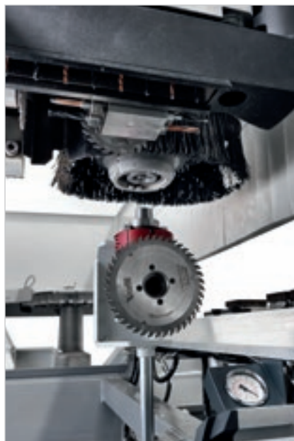
Устройство Pick Up позволяет оснащать магазины на станке.
