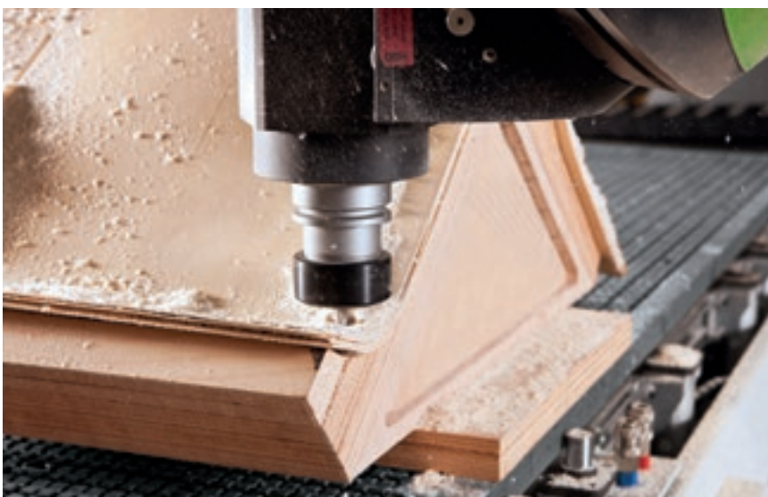
Фиксация деталей на специальных вакуумных контршаблонах.
