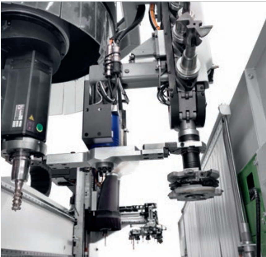
Устройство Pick Up позволяет оснащать магазины на станке.
